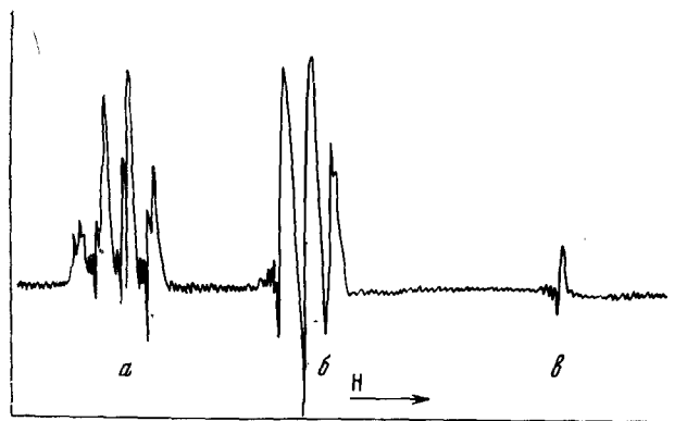
Рис. 8. Спектр ПМР метиллития в диэтиловом эфире; а — линии группы \text{CH}_2 эфира, б — линии \text{CH}_3 эфира, в — линия \text{CH}_3 метиллития (ширина \sim 1,4 гц, f_{\text{рез}} = 22,68 мгц)
