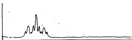
Рис. 3. Спектр ЯМР В 11 диборана 24 ( f_{\text{рез}} = 12,3 \text{ мгц} )
